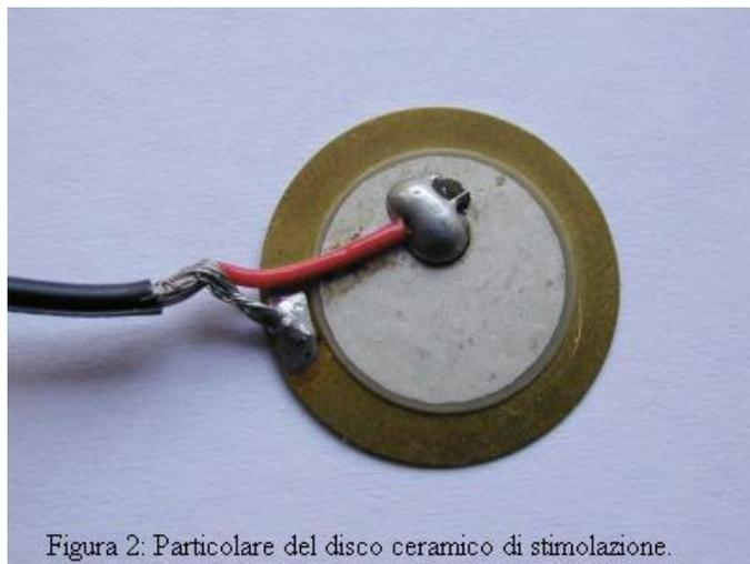
Figura 2: Particolare del disco ceramico di stimolazione.
