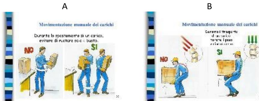
Fig. 2A, 2B. Movimentazione manuale dei carichi, corretto sollevamento/appoggio di un carico.
