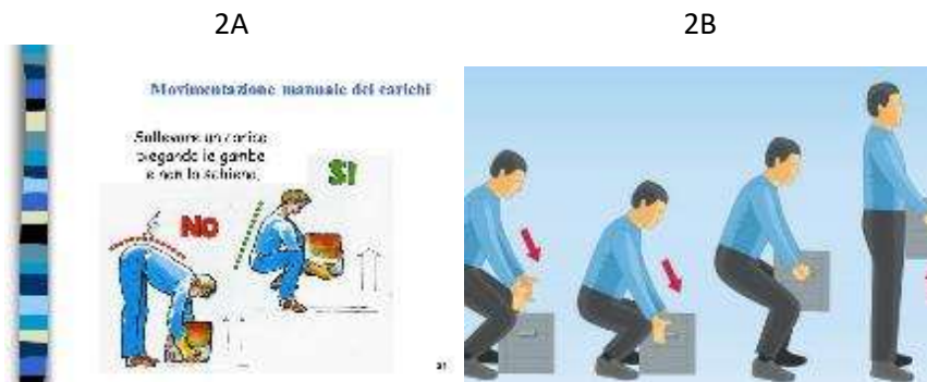
Fig. 2A, 2B. Movimentazione manuale dei carichi, corretto sollevamento/appoggio di un carico.
